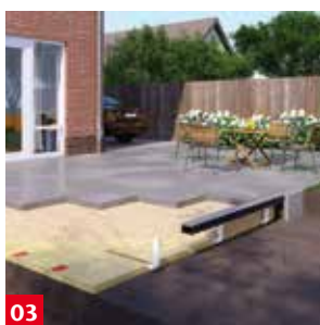
Infiltratie van regenwater direct onder het terras
