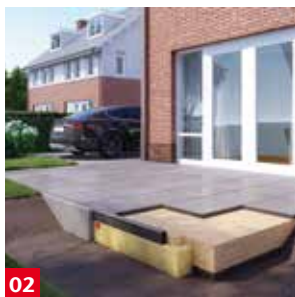
Infiltratie langs het terras met infiltratiebuffer
