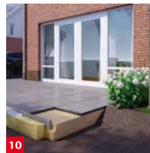
Infiltratie langs het terras met infiltratiebuffer
