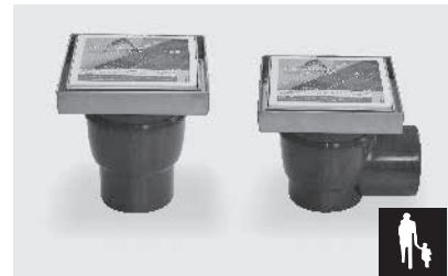
BlueStone vloerput met onder- en zij-uitlaat. Inbouwdiepte 25 +2 tot 5 mm click
