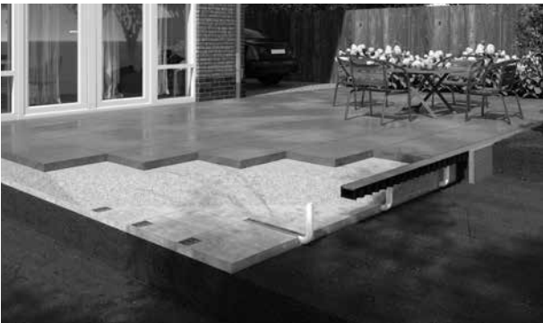
03 - Infiltratie van regenwater direct onder het terras
