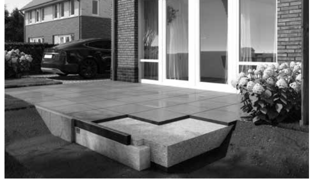
02 - Infiltratie langs het terras met infiltratiebuffer
